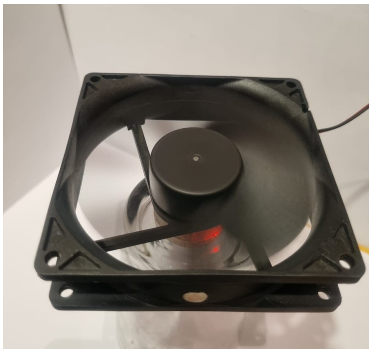
Figura 7: ventoinha com sensor acoplado na horizontal
