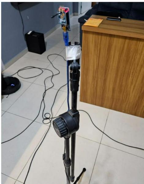
Figura 29 - Montagem do receptor (Rx) para plataforma Zigbee. Fonte: Autor.
