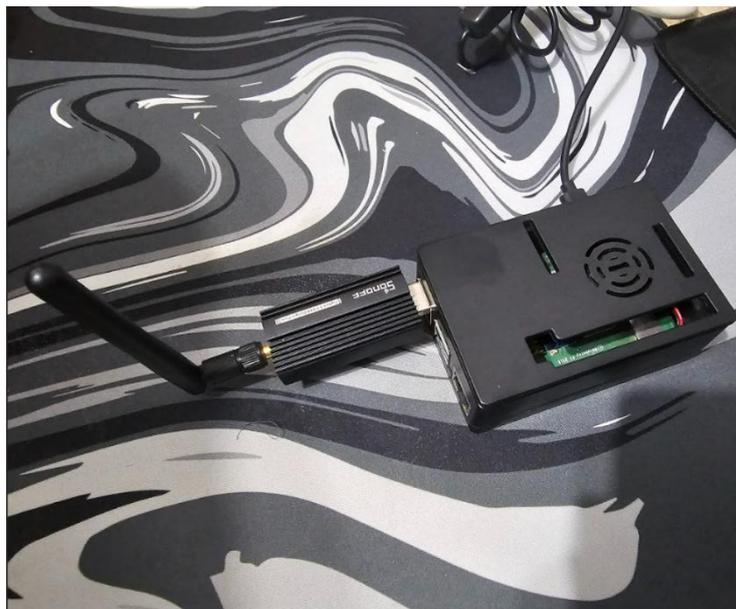
Figura 19 - Hub zigbee conectado ao Raspberry Pi. Fonte: Autor.
