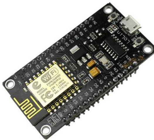
Figura 14 - ESP-8266. Fonte: Espressif Systems.
