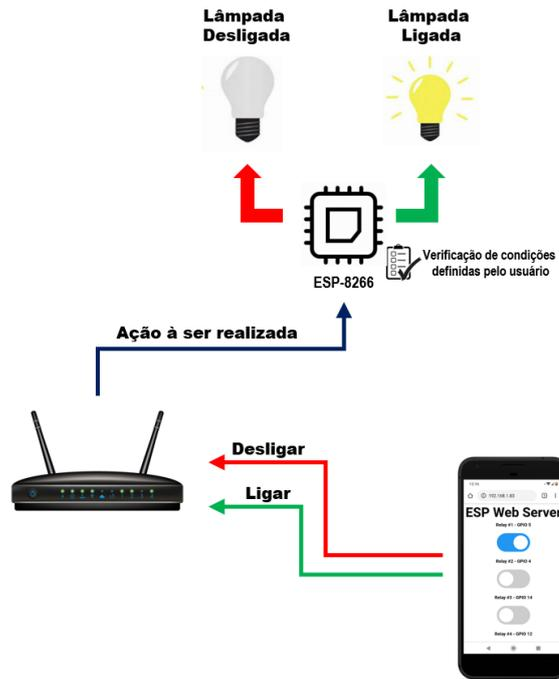
Figura 23 - Diagrama de funcionamento do sistema de interruptor inteligente. Fonte: Autor.
