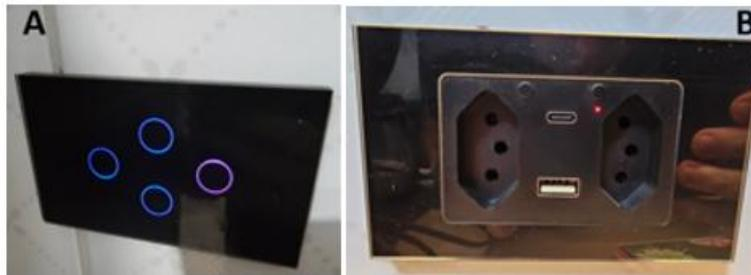
Figura 3 - Exemplos de atuadores elétricos: (A) Interruptor, (B) Tomada. Fonte: Autor.
