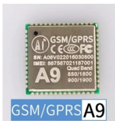
Figura 5 - Submódulo A9G da empresa AI-Thinker. Fonte: AI-Thinker.
