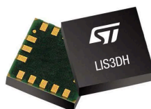
Figura 7 - Circuito integrado do acelerômetro LIS3DH. Fonte: STMicroelectronics.
