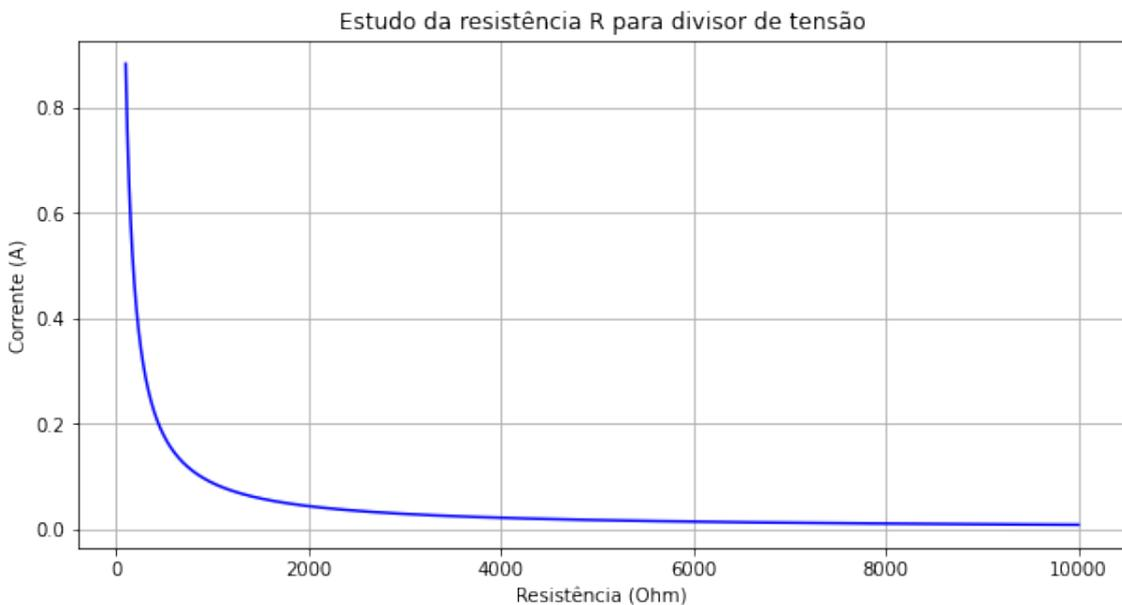
Figura 9 – Gráfico da variação de corrente com a alteração do valor de  $R$ .
