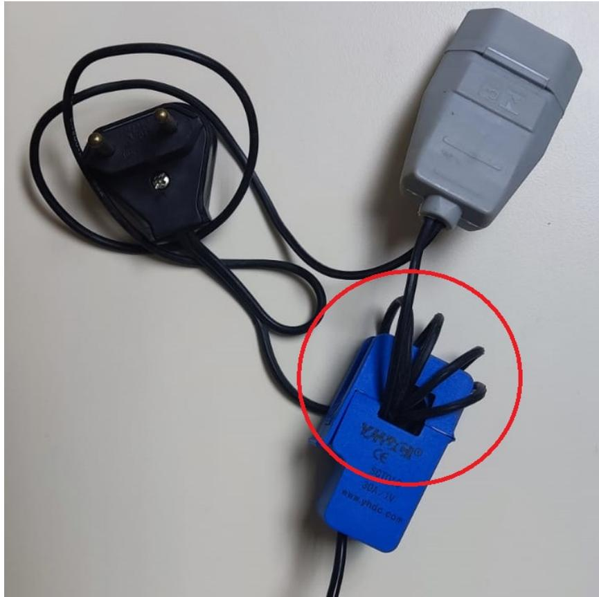
Figura 48 – Configuração com 5 voltas no transdutor de corrente.
