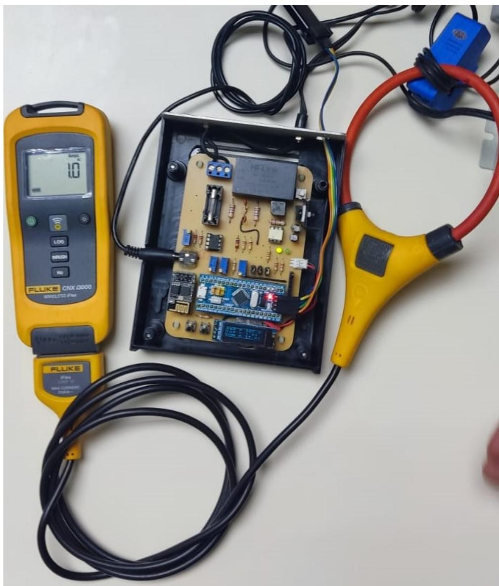
Figura 42 – Validação do ajuste de corrente com o Fluke CNXi3000.
