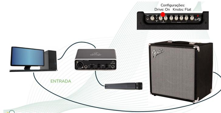
Figura 4: Representação da gravação de áudios com efeito aplicado através da realimentação do áudios limpos gravados anteriormente.
