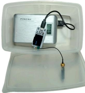
(a) Parte interna do transmissor com caixa plástica.
