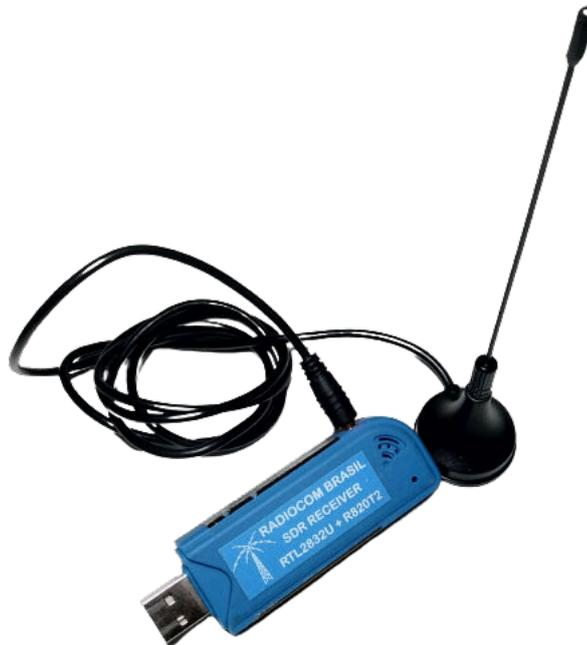
**Figura 25** – RTL-SDR utilizado na avaliação experimental.
