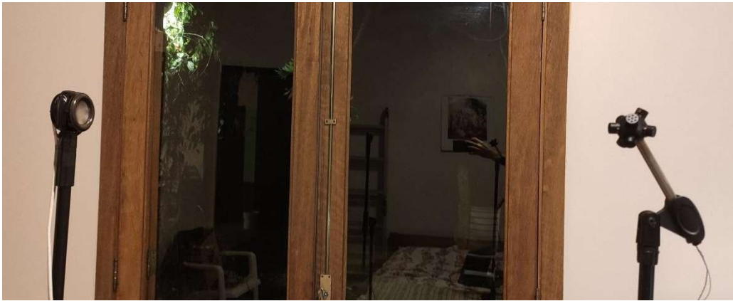
Figura 31: montagem do arranjo à mesma distância do alto falante para aferição da sensibilidade da cápsula apontada.
