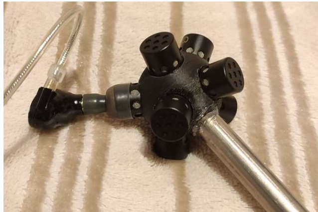
Figura 33: acoplamento do fone à frente da cápsula para medição de máximo SPL.
