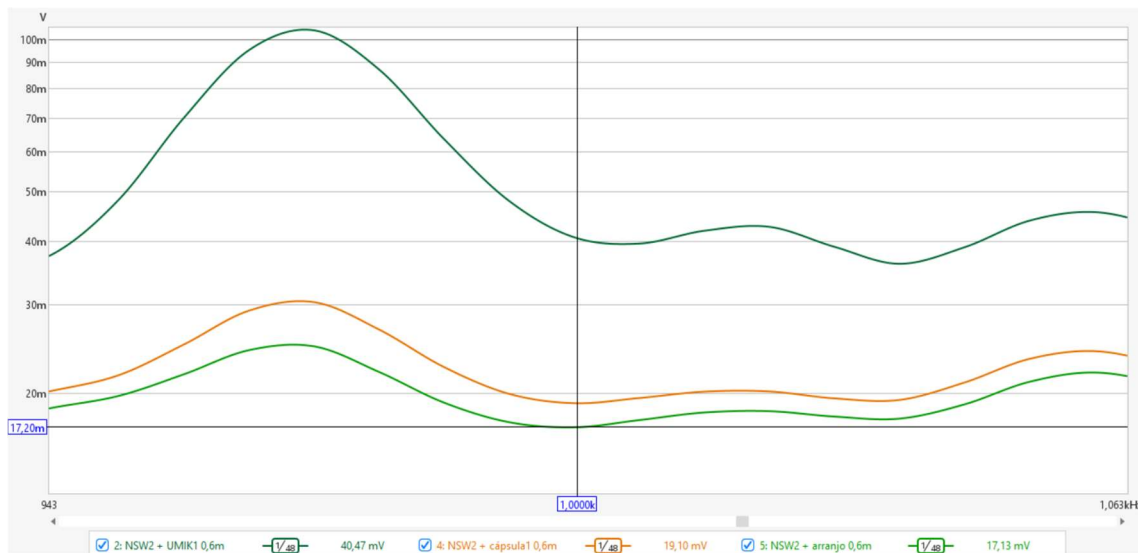
Figura 32: sinais produzidos pelos microfones com o sinal acústico em 94 dB SPL à distância de 0,6 m do alto falante – microfone de medição (acima em verde escuro), cápsula suspensa fora do arranjo (laranja), e cápsula inserida no arranjo (em verde claro, com o marcador em 1kHz para identificação da sensibilidade).
