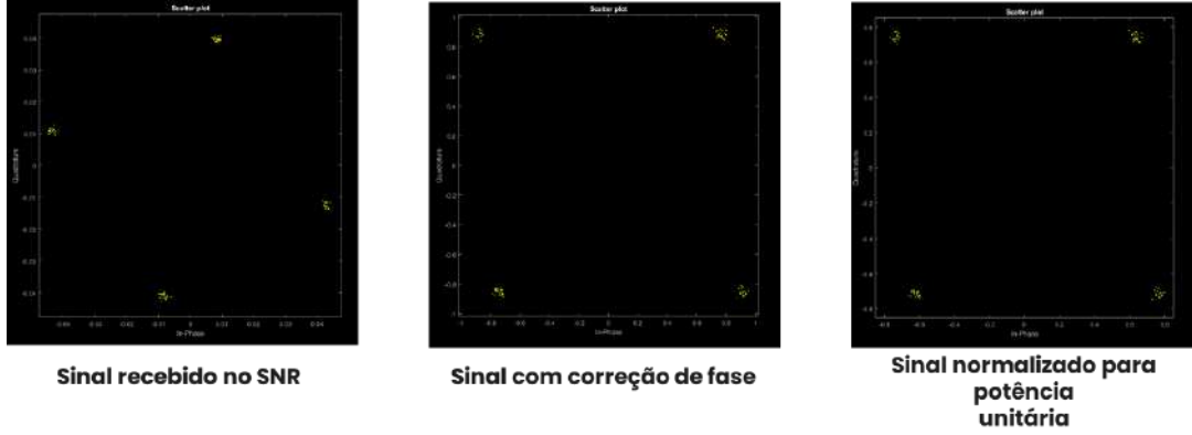
Figura 46 – Constelações de um frame em modulação QPSK recebido pelo SDR, após a aplicação dos processos de correção de fase e normalização de potência.
