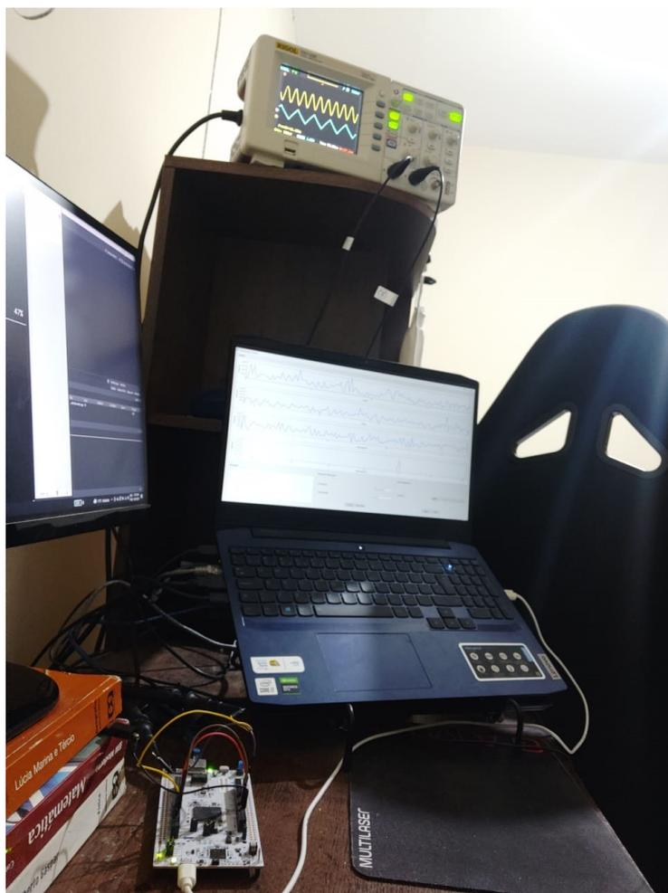
Figura 17: Ambiente de testes, é possível visualizar a placa de desenvolvimento, o Software de Visualização e o osciloscópio conectado a placa de desenvolvimento para aquisição dos sinais.
