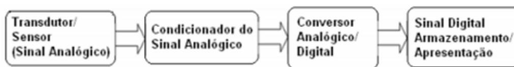
Figura 3.19 – Modelo em blocos de um sistema de aquisição de dados Fonte: Silva Nogueira (2008).
