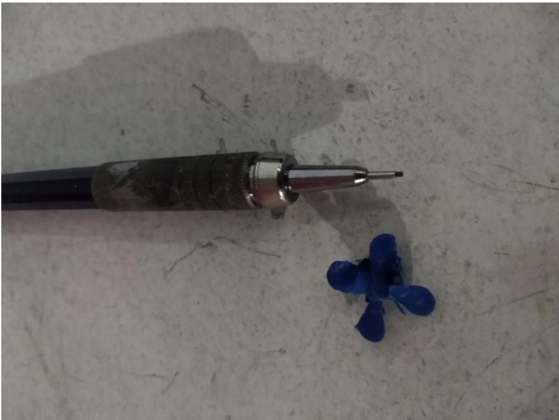
*Figura 20: Primeiro modelo de hélice produzido pela impressão 3D, fonte: autoria própria.*
