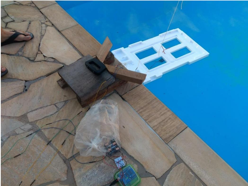
*Figura 56: Aparato construído para medida de empuxo do sistema de propulsão a partir do acionamento pela interface gráfica, fonte: autoria própria.*
