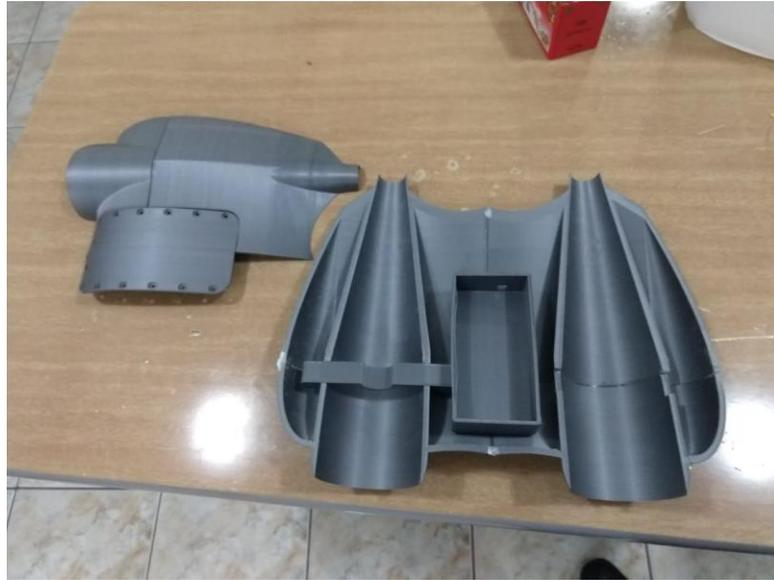
*Figura 76: Parte inferior e metade superior do corpo construídas. Escotilha e suporte parcial impressos, fonte: autoria própria.*
