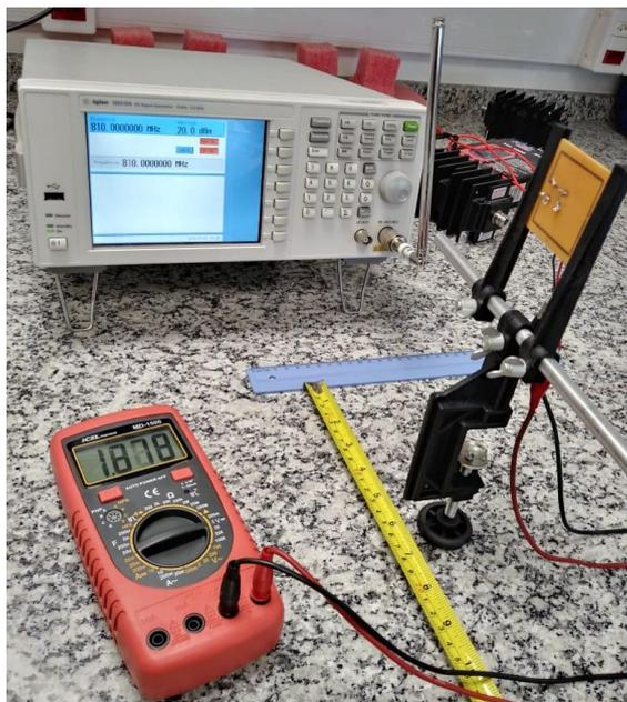
Figura 14 – Esquema de transmissão antena monopolo e SRR com componentes de encapsulamento comum [6]
