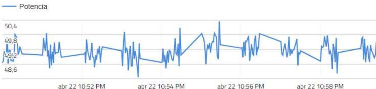
**Gráfico 6: Potência RMS Ventilador sem o uso do Modem PLC**
