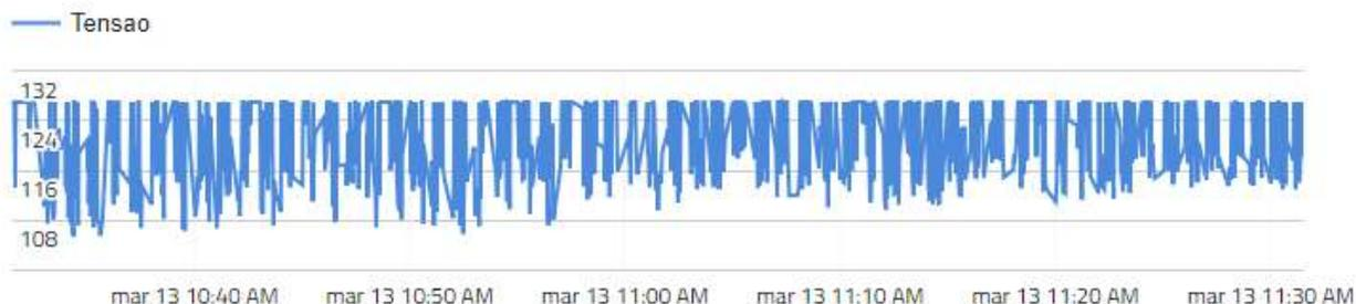
**Gráfico 1: Tensão RMS ventilador com uso do modem PLC**
