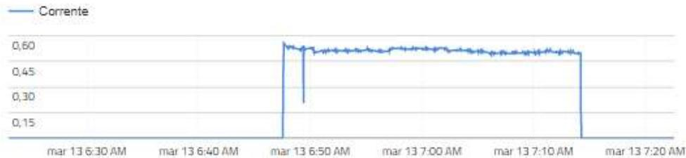
**Gráfico 14: Corrente RMS TV Smart Samsung com o uso do modem PLC**
