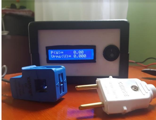
**Figura 37: Medidor Inteligente PLC in Home**
