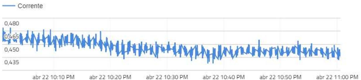
**Gráfico 4: Corrente RMS ventilador sem o uso do Modem PLC**
