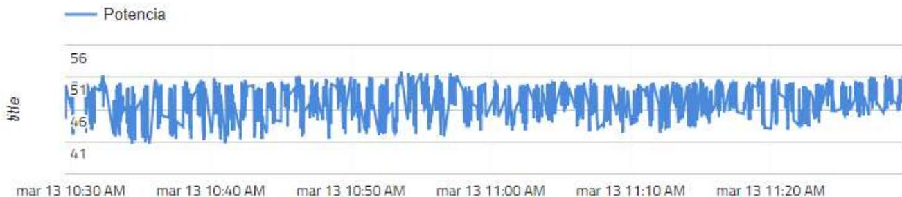
**Gráfico 5: Potência RMS ventilador com uso do modem PLC**
