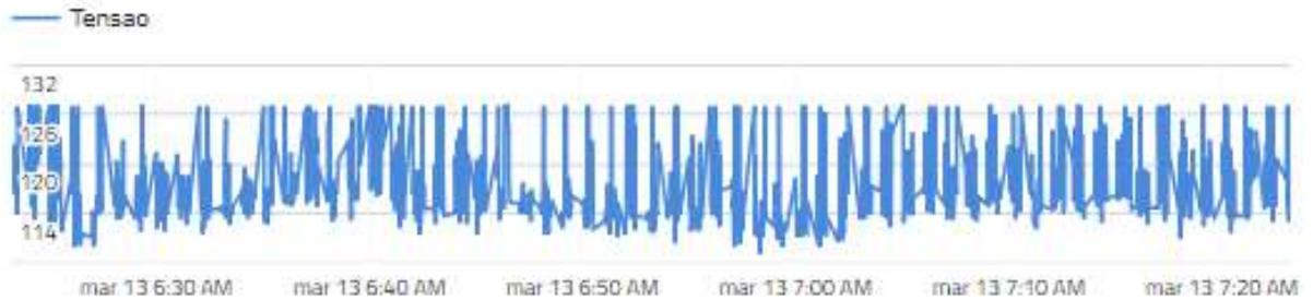
**Gráfico 13: Tensão RMS TV Smart Samsung com o uso do modem PLC**
