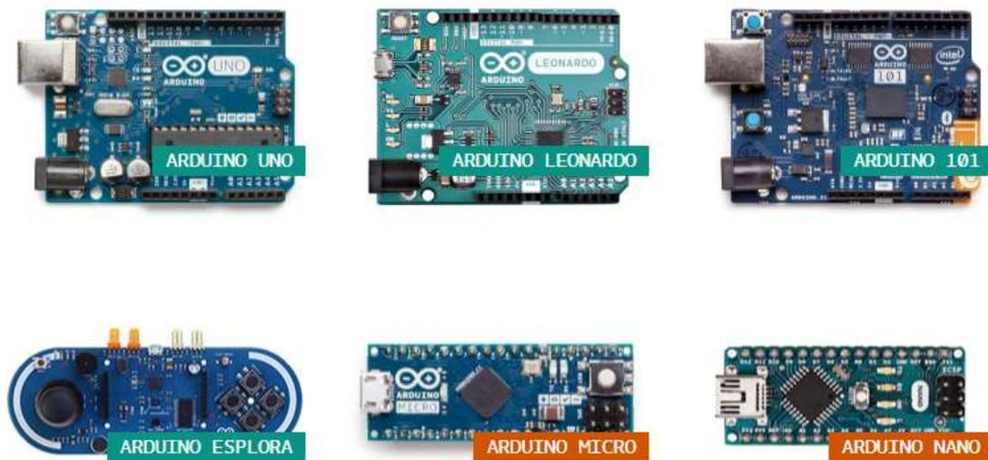
Figura 16: Principais placas de desenvolvimento da família Arduino [16].
