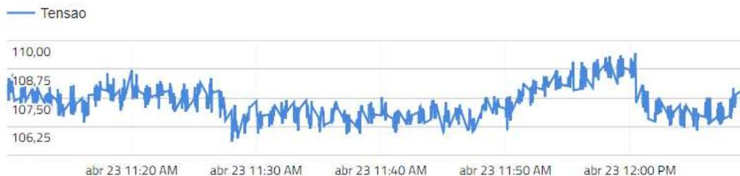
**Gráfico 8: Tensão RMS geladeira Brastemp sem o uso do modem PLC**
