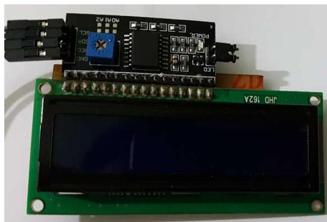
**Figura 27: Módulo I2C ligado ao display**
