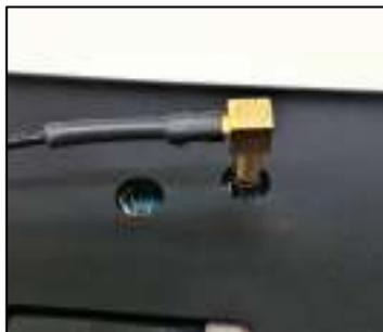
Em seguida, foram realizados experimentos no esquema MIMO, conforme mostra a Figura 8.4, em que foram conectados dois cabos, o primeiro cabo foi conectado da mesma forma que o esquema SISO, e o segundo cabo foi conectado em outra saída do equipamento e conectado na outra antena com a finalidade de comunicação MIMO.
