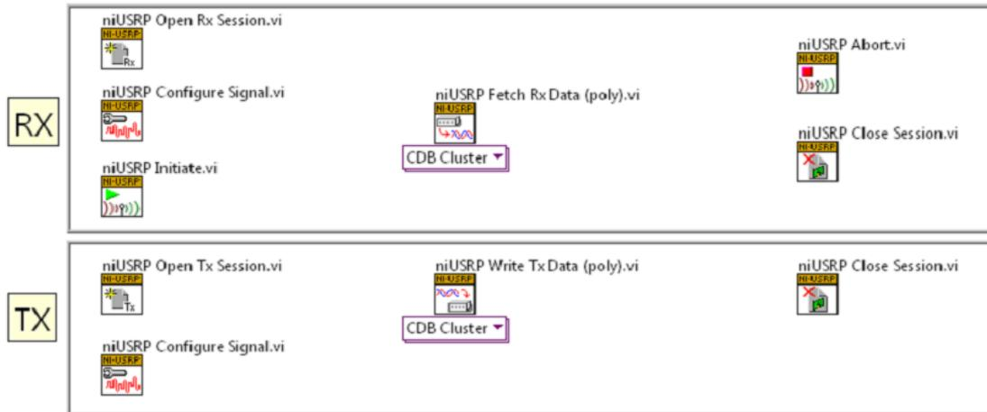
Figura 39 - Conjunto de VIs usados para realizar a configuração da USRP através do LabVIEW.
